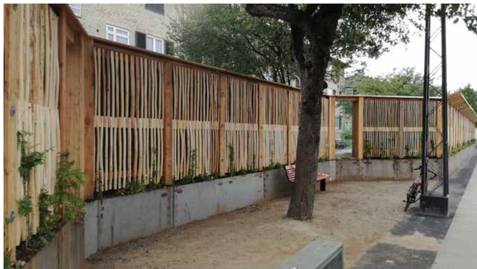
Et eksempel på en støjskærm, der foruden at dæmpe støj også kan oplagre regn fra skybrud. Foto: Miljøstyrelsen.
